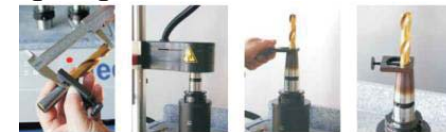
Festlegen der Auskraglänge des Schneidwerkzeugs
