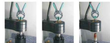
Druckfeder ist gespannt, das Schneidwerkzeug wird von der Zange gehalten. Schrumpffutter erwärmen
